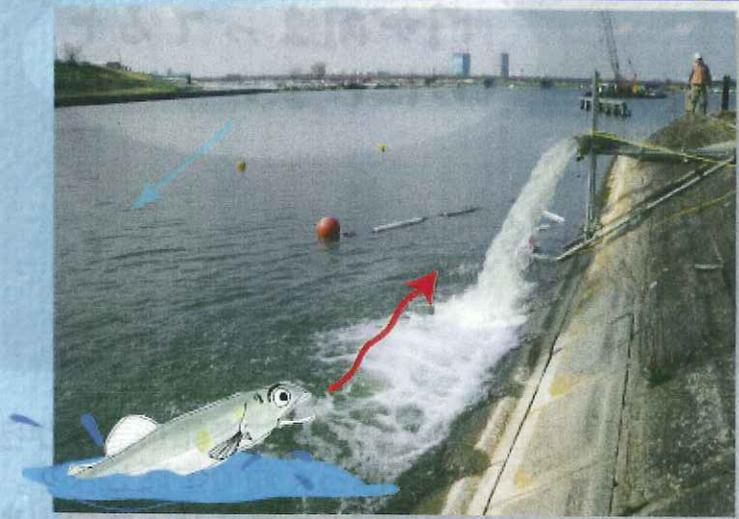
閘門の開閉は限られており、水の流れが十分ではありません。そのため、ポンプを設置して水の流れを作りだし、この流れによってアユを閘門の上流へ誘導することができるのか調べています。
